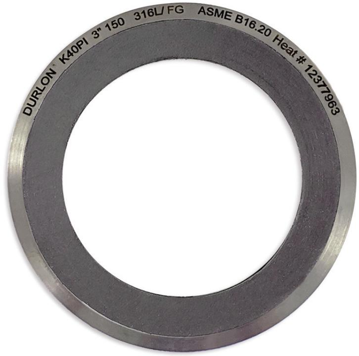
Las juntas de perfil Kamm Durlon® poseen un núcleo de metal sólido con ranuras dentadas concéntricas mecanizadas en las caras superior e inferior. El núcleo de metal es generalmente de acero inoxidable pero puede ofrecerse en distintas metalurgias a solicitud del cliente.
