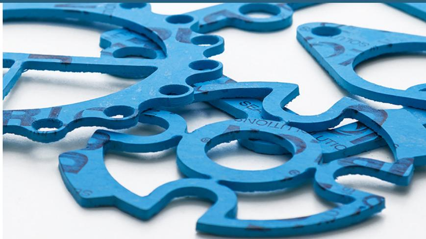
Durlon® 8700 es un material de alto rendimiento para empaquetaduras, ideal para procesos que requieran una lámina de neopreno (CR) unida, con excelentes características de troquelado en molde/manual. Este producto tiene excelente resistencia al ozono, los aceites, los solventes no aromáticos y muchos refrigerantes.
