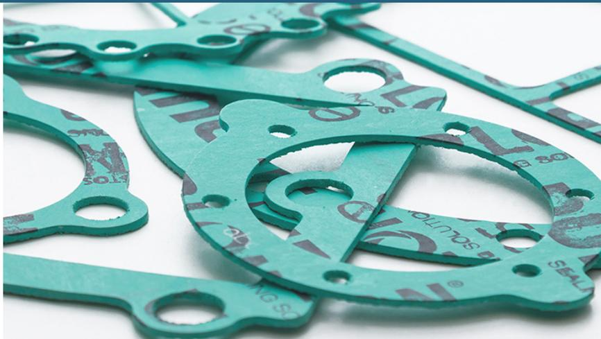
Durlon® 7925 es una lámina de servicio general y económica para empaquetaduras hecha con aglomerante NBR (caucho de nitrilo butadieno), ideal para servicios moderados en tuberías y equipos. Con aplicaciones en vapor, hidrocarburos y refrigerantes, y una alternativa cuando la temperatura y la presión son inferiores a 260 °C y 1200 psig (véase la gráfica PxT para validar la información).
