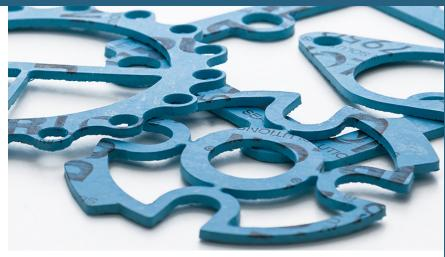
Durlon® 7950 es una lámina de servicio general y económica para empaquetaduras hecha con aglomerante NBR (caucho de nitrilo butadieno), ideal para servicios moderados en tuberías y equipos. Con aplicacinoes en vapor, hidrocarburos y refrigerantes, y una alternativa cuando la temperatura y la presión son inferiores a 260 °C y 1200 psig (véase la gráfica PxT para validar la información).
